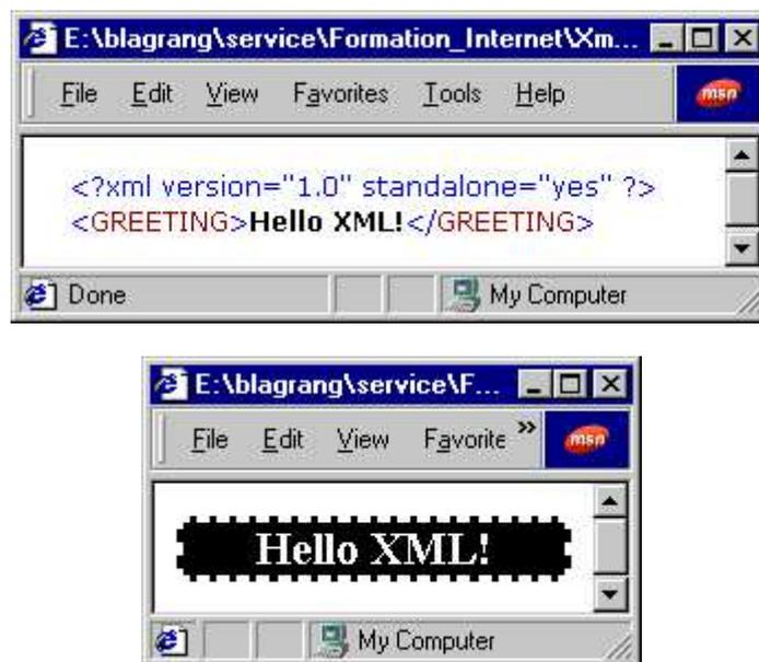
FIG. 14.3 – Comparaison du layout rendu par IE5.5 pour le même fichier XML sans et avec lien vers un fichier CSS
